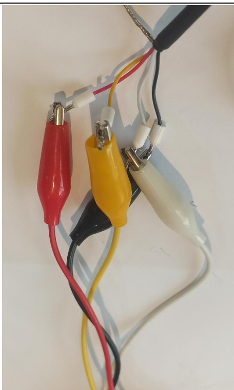
شکل ۱۱: اتصال سیم‌های انکودر به تستر
