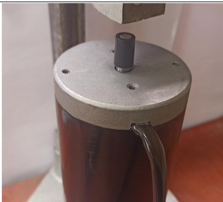
شکل ۶: نصب کوپلینگ بر روی شفت موتور با استفاده از پرس دستی
