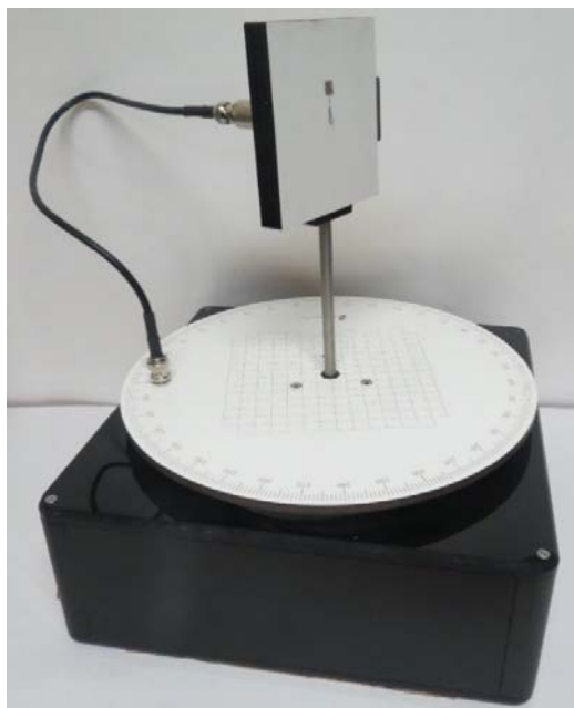
شکل ۸۹: نصب آنتن میکرواستریپ روی پایه چرخان با استفاده از میله فلزی
