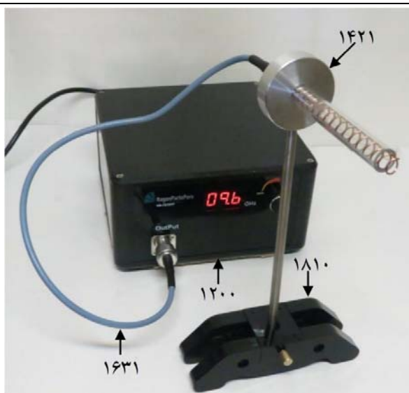
شکل ۹۲: نحوه اتصال آنتن هلیکال به مولد سیگنال مایکروویو با استفاده از کابل فرکانس بالا
